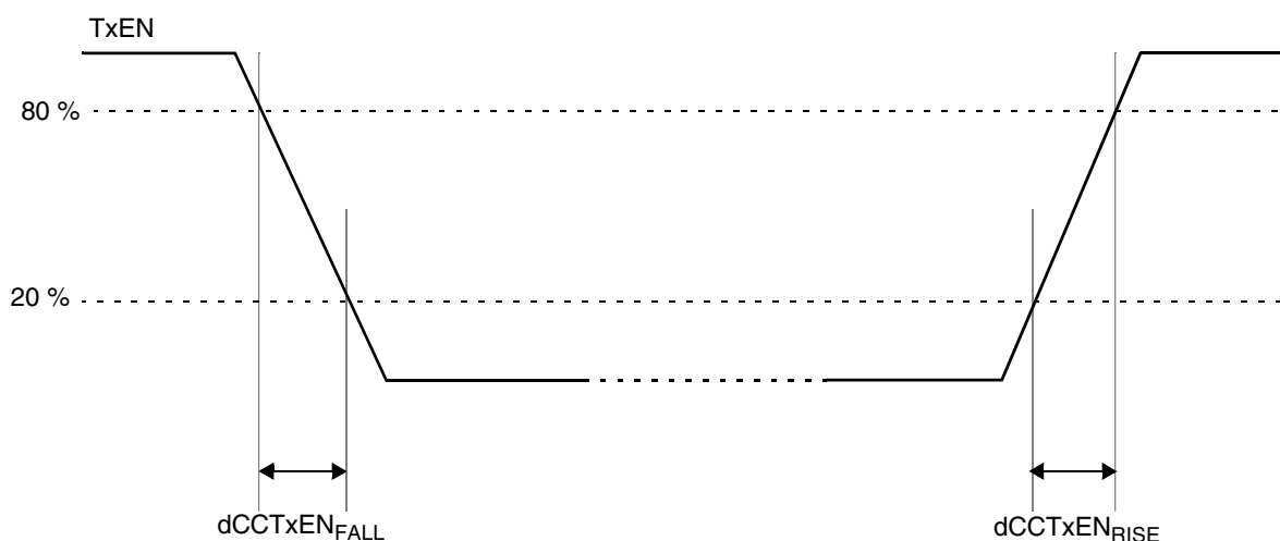
Figure 17. FlexRay TxEN signal
